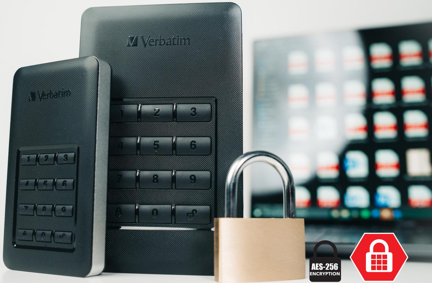
La crittografia hardware AES a 256 bit crittografa tutti i dati in tempo reale sull'unità. Per potervi accedere è necessario digitare il codice tramite la tastiera integrata. Una soluzione di archiviazione semplice e sicura.
